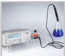
Genauere Temperaturmessung mit Messfühler
